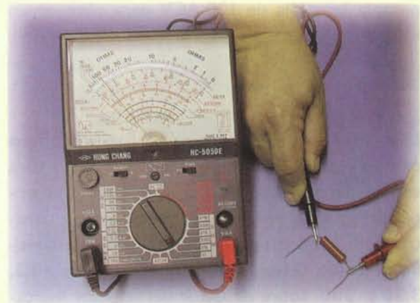
Figura 3.9. Medida de una resistencia de 1.000\Omega
